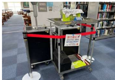
室內空品定檢 (CO 2 , PM 10 , 甲醛) 第一校區 圖書館三樓西文書庫閱讀區
